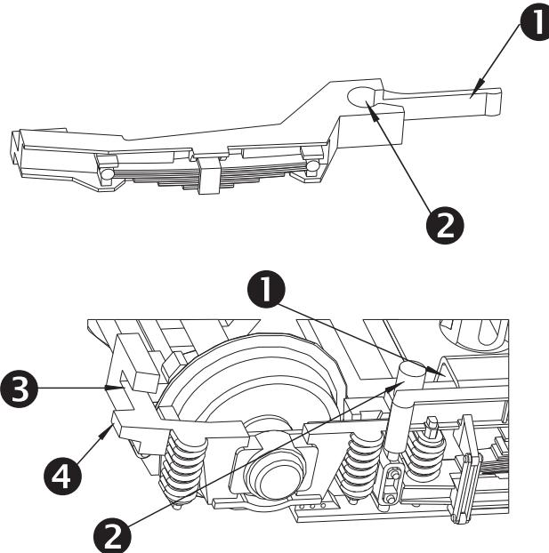
**2** (DE) Sitz auf Führungsstift überprüfen! Federpaket muss sich leicht bewegen lassen und bei Geradeausfahrt in seine Ausgangslage zurückfedern.
