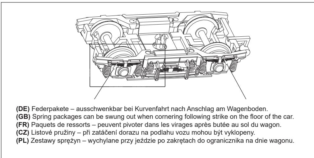
(DE) Bei Kurvenradien unter 310 mm müssen diese Federpakete entfernt werden.
