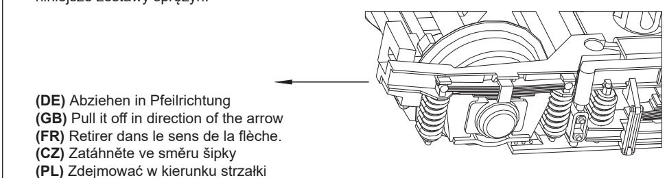
**1** (DE) Wiedermontage: Federzunge in Freiraum zwischen Achslagerbrücke (Blechteil) und Drehgestellblende einführen.
